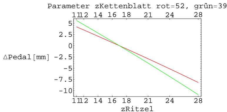
Auch mit einer Kettenschaltung tritt ein merklicher Pedalrückschlag auf, der um so größer ist, je stärker die Ritzelgröße von dem für die Optimierung zugrunde gelegten Wert abweicht. Auffällig ist die starke Abhängigkeit von der Ritzelgröße bei eher geringem Einfluß der Zähnezahl des Kettenblattes. Schaut man sich die Abhängigkeit der Pedalposition von der Einfederung für drei der acht verschiedenen Ritzelgrößen genauer an,
