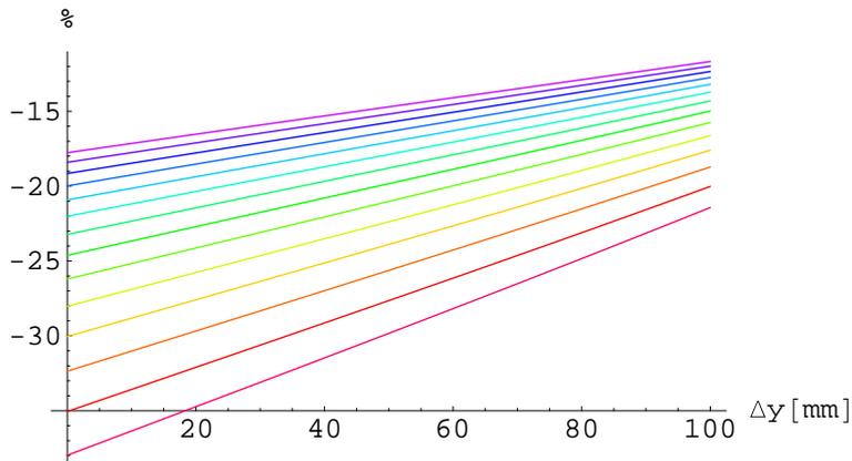
Die Farbuordnung zu dem jeweiligen Gang entspricht der vorhergehenden Darstellung. Je nach gewähltem Gang tritt eine mehr oder weniger starke Rückwirkung des Antriebes auf die Federung auf, die zum Großteil aus dem durch die Schaltnabe in die Schwinge eingeleitetem Drehmoment resultiert. Dies soll im folgenden noch einmal verdeutlicht werden. Dazu werden die einzelnen Effekt getrennt für eine Einfederung von 25% des gesamten Federweges betrachtet.
