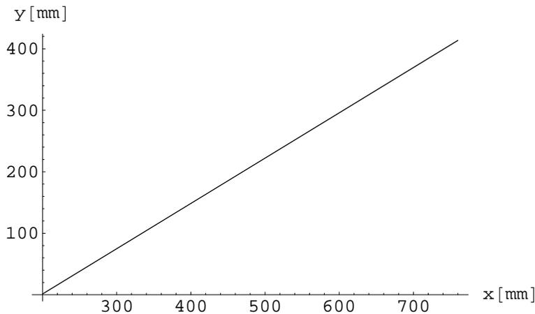
Diese Linie ist in die [CAD-Zeichnung](..Images/T1-20-20-v12.gif) eingezeichnet. Hier kann die Umlenkrolle auf dem Schnittpunkt dieser Linie mit der Mittellinie der Schwinge angeordnet werden.
