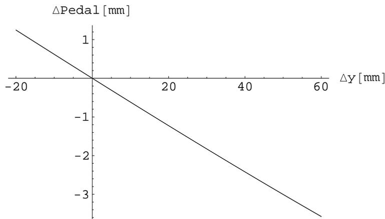
Die gewählte Lage der Umlenkrolle ist noch nicht optimal. Für optimale Verhältnisse sollte die Änderung der Pedalposition bei  $2/3$  des Federweges etwa Null betragen. Gesucht ist der Bereich für die Position der Umlenkrolle, in dem diese Forderung näherungsweise erfüllt ist. Zu diesem Zweck wird der Pedalrückschlag als Funktion der x und y Koordinaten der Umlenkrolle in einer Konturgrafik dargestellt.
