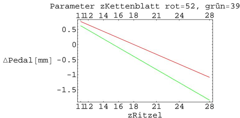
Die obere rote Kurve in diesem Diagramm entspricht dem 52iger und die untere grüne dem 39iger Kettenblatt. Es zeigt sich, wie erwartet, daß bei anderen Kombinationen von Kettenblatt und Ritzel wieder ein merklicher Pedalrückschlag auftreten kann. Eine Optimierung der Geometrie ist nur in einem nicht zu breiten Entfaltungsbereich möglich. Je nach vorwiegendem Einsatzzweck muß die Dimensionierung für die am häufigsten genutzte Kettenblatt Ritzel Kombination vorgenommen werden.
